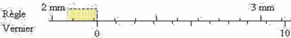
Dans cet exemple, aucun trait du vernier ne coïncide parfaitement. Néanmoins, la 2<sup>e</sup> et la 3<sup>e</sup> division sont assez près d'un trait de la règle. La longueur à mesurer est alors supérieure à 2,2 mm, mais inférieure à 2,3 mm; l'on dira 2,35 mm  $\pm$  0,05 mm.
