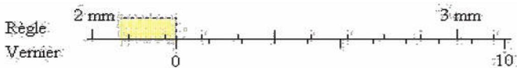
Dans cet exemple, la 3<sup>e</sup> division du vernier coïncide avec un trait de la règle. La mesure est donc 2,3 mm  $\pm$  0,1 mm.
