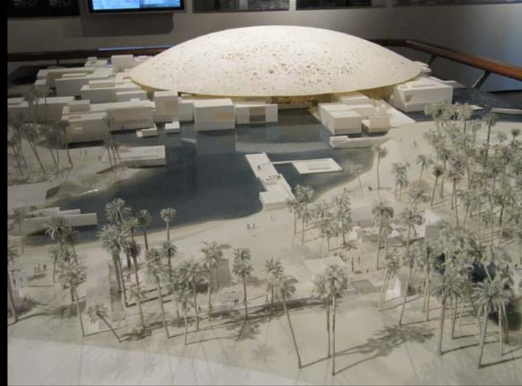
Maquette d'architecture à l'échelle 1:200 réalisée avec du carton, c'est une maquette monochrome.
