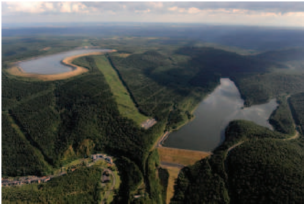
FIGURE 4.2 – Station de transfert d'énergie par pompage
